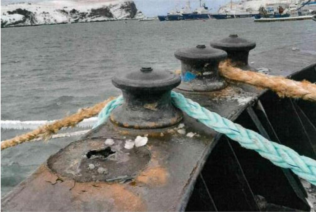
Рис. 4. Место фиксации швартовного роульса на козырьке фальшборта
